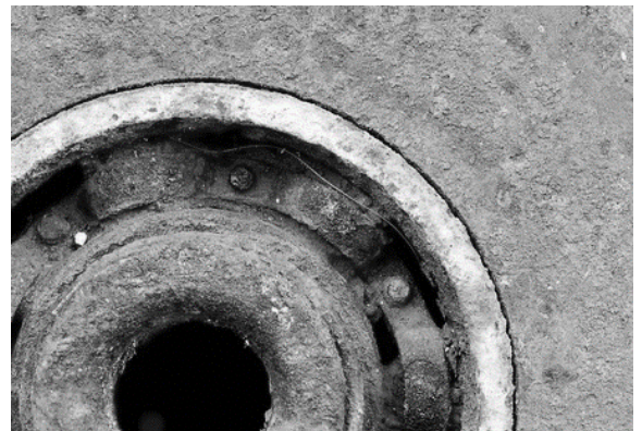
Roulement à billes oxydé
