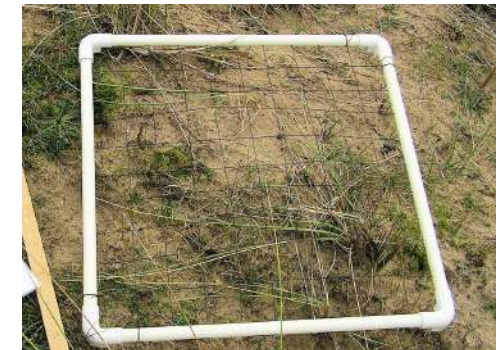
▲ FIGURES a-b. Transects dessinés au sol avec des baguettes de bois (a) et transect mobile à poser (b) . D'après le compte Twitter @DrTrevorDines (a) et le site Aquaportail.com (b) (consultation mars 2018)
