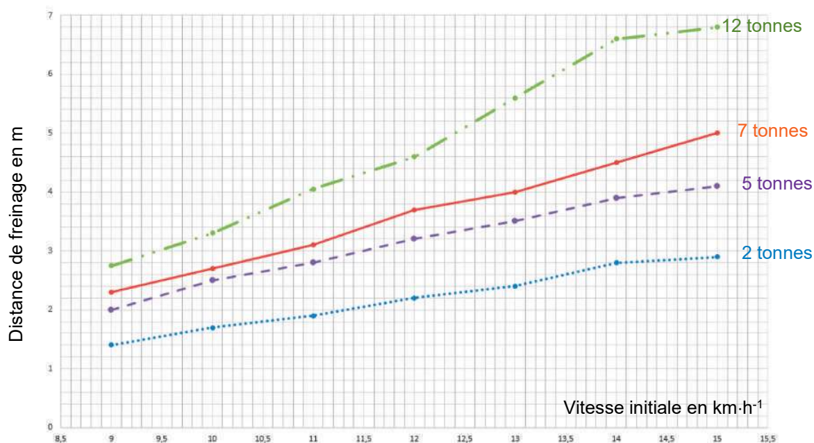
Figure 11 : résultats des essais de freinage.
