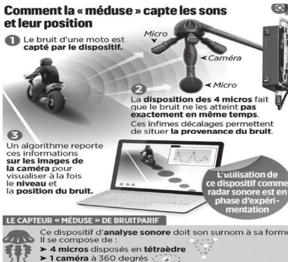
Figure 2. Fonctionnement du dispositif « méduse ». https://www.leparisien.fr/
