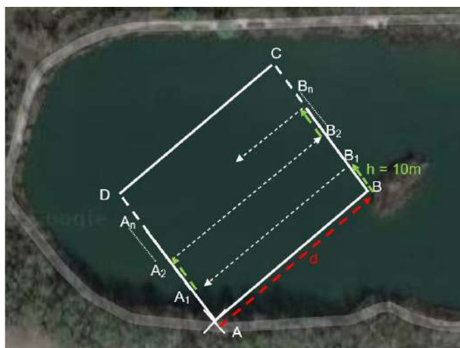
figure 17 : représentation schématique du balayage en vue de dessus de la zone de pêche
