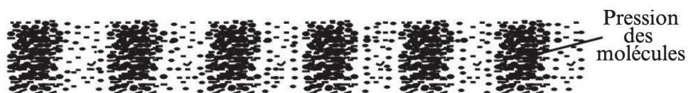
Compression et dépression des molécules présentes dans l'air
