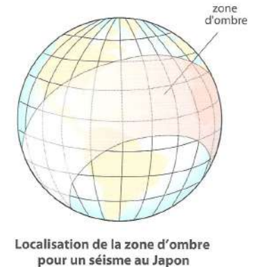
▲ FIGURE 17. Une zone d'ombre entre 105° et 143° due au noyau externe. Les ondes directes disparaissent à 105° , soit 11500 km de distance à l'épicentre. Les ondes doublement réfractées réapparaissent à 143° , soit 14500 km de l'épicentre. D'après LAGABRIELLE et al. (2013).
