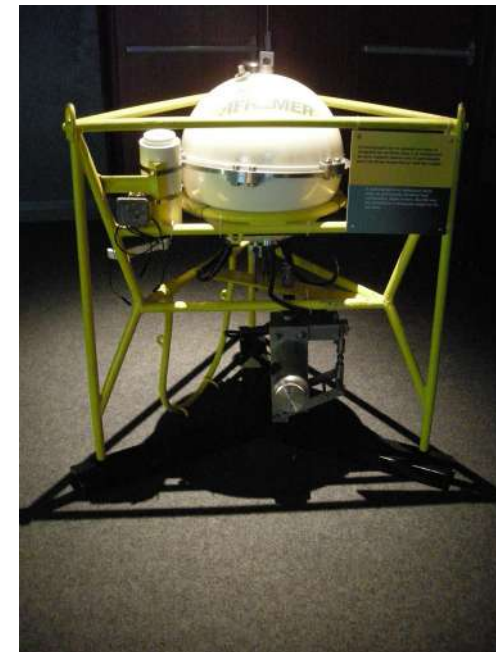
▲ FIGURE 8. Sismographe IFREMER de fonds océaniques. Wikipédia (janvier 2022)
