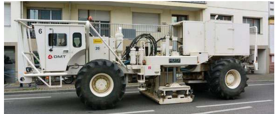
▲ FIGURE 49. Un camion vibreur. https://www.lemoniteur.fr/article/des-camions-vibreurs-echographient-la-ville-de-strasbourg.812829 (consultation janvier 2022)
