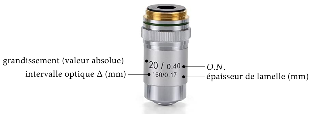
FIG. 28 – Exemples d'indications figurant sur l'objectif d'un microscope.
