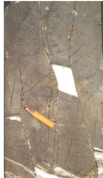
▲ FIGURE 65. Stylolites, fentes de tension, écaille de calcite. D'après MATTAUER (1998)
