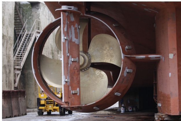
FIGURE 13 – Protection par anode sacrificielle
